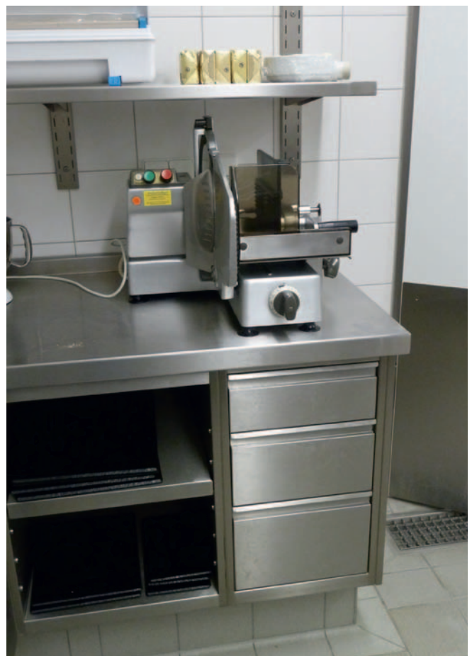
Abb. 8 Geeignete Aufstellung der Aufschnittschneidemaschine
