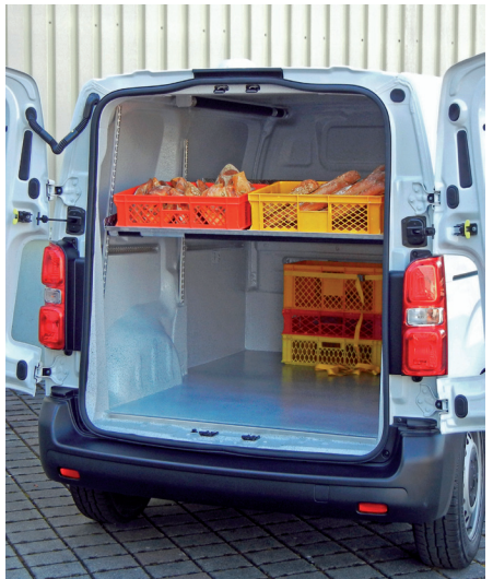
Abb. 10: Laderaumaufteilung durch Zwischenboden
