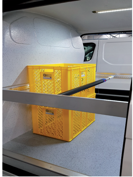
Abb. 8: Ladungssicherung durch Absperrrange und Absperrbrett
