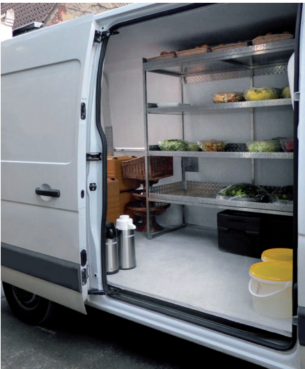
Abb. 9: Innenausbau mit Regalsystem
